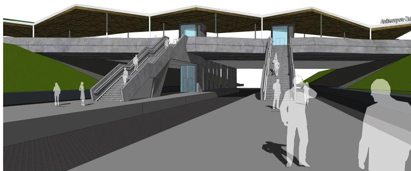
Les accès existants (escaliers en béton et escalators) aux quais de la gare d'Anvers Sud seront démolis et remplacés par un ascenseur à vélos et des escaliers en béton préfabriqué.
